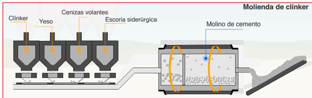
Figura 2.6: Molienda del cemento y demás componentes (Fuente: Instituto Español Del Cemento y Sus Aplicaciones [2])
