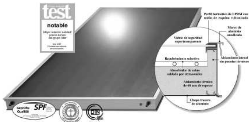
Figura 1 El Euro-C20 - un captador altamente eficaz que se instala rápidamente
