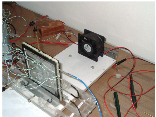
-Esquema de ensayo para la medidas de temperaturas con un flujo de aire en la cara caliente para un prototipo de PTA.
