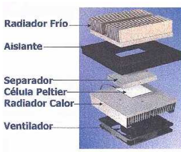
Figura 2-5 Montaje del módulo termoeléctrico
